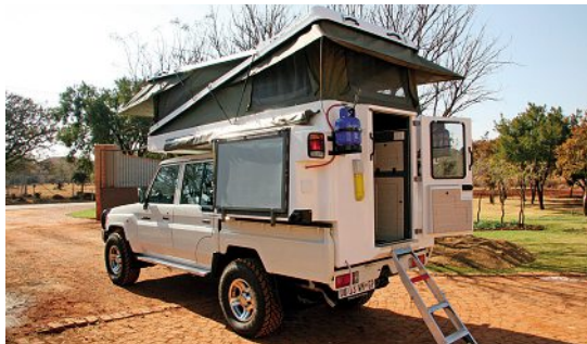
Die Compact-eenheid op 'n Land Cruiser. Dit duur minder as 'n halfuur om die eenheid te monteer.
